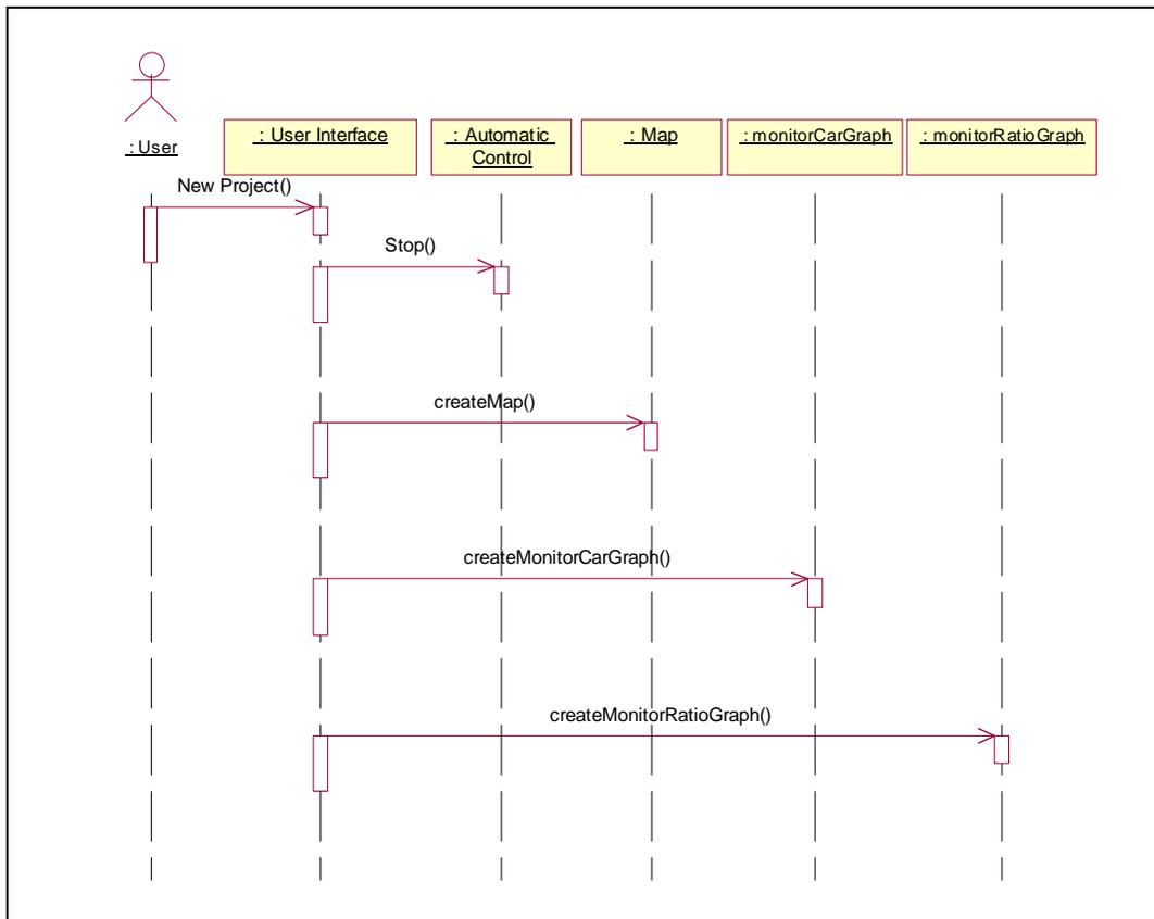
รูปที่ ค-2: Sequence Diagram ของ New Project
