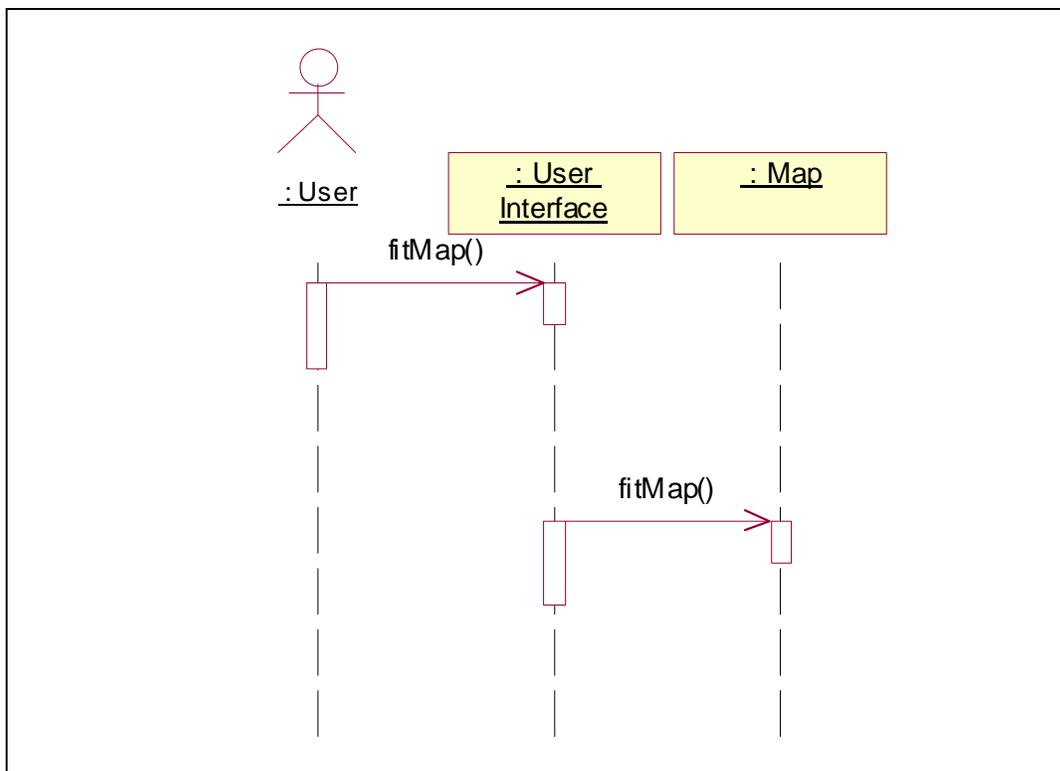
รูปที่ ค-16: Sequence Diagramของ Fit Map
